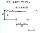
②けがいた位置に振動ドリル(φ10 mm) で深さ 55mm の穴をあけ、 付属のナイロンアンカーを挿入 します。
